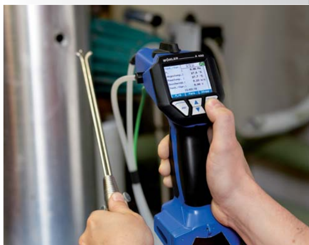
Detail Messsonde für Ventilationsverlust
