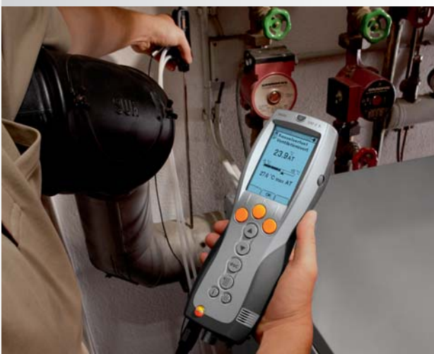
Messung der Strömungsgeschwindigkeit in der Abgasleitung
